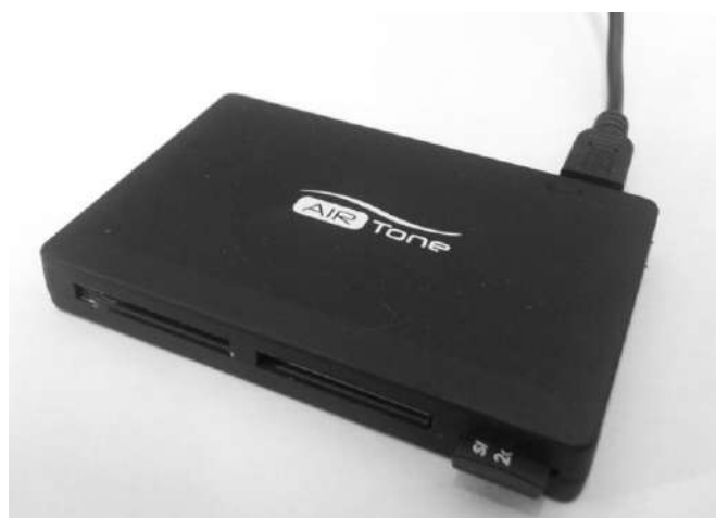
Рисунок 19 – специализированное устройство чтения карты памяти (Card Reader)
